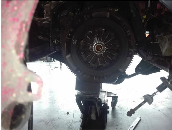
El único problema que nos encontramos fue al extraer la caja del bloque motor, contenía aceite debido al reten del cigueñal , con lo cual sacamos el volante de inercia para llegar hasta el reten y sustituirlo.
