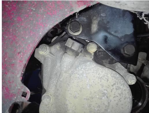
Una vez sueltos los tacos, pasamos a soltar los tornillos que sujetaban la caja de cambios al bloque motor. Con la ayuda de un compañero haciendo palanca para facilitar la salida de la caja, otro sostenía la caja y poco a poco la sacamos fuera del vehículo.
