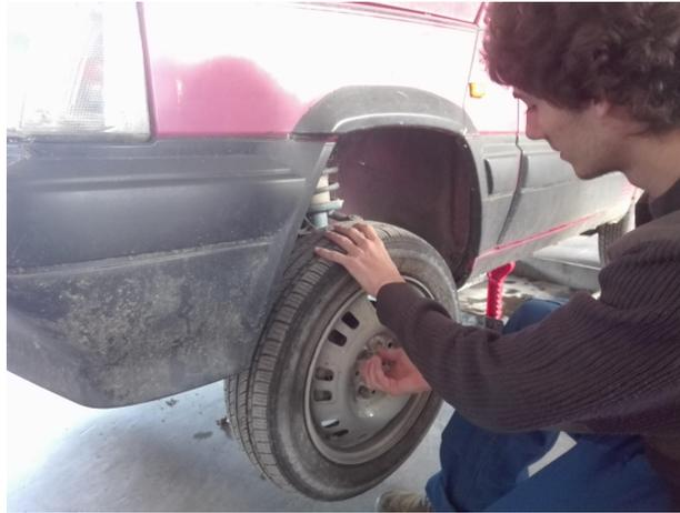
Extraemos los palieres pero para poder sacar los palieres es necesario soltar los tornillos que sujetan la suspensión a la mangueta y el de la bieleta de mando si es necesario, una vez sueltos separamos la mangueta del palier para poder acceder a ellos.
