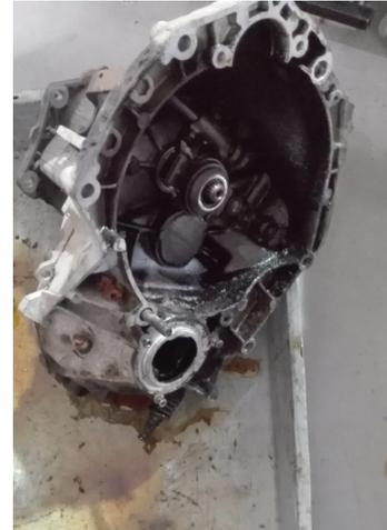
Ya con la caja fuera nos encontramos con el embrague soltamos el plato de presión , extraemos el disco y el volante de inercia.
