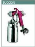
De igual forma, el diámetro de la boquilla o pico de fluido debe ajustarse a la viscosidad de la pintura y al tipo de pistola, ya que a mayor viscosidad mayor diámetro será necesario y una pistola de succión frente a una de gravedad, precisará el mismo o un tamaño mayor para la aplicación de la misma pintura, ya que la de succión ha de contrarrestar la fuerza de gravedad. Recuerda que el diámetro de boquilla que ha de emplearse se indica en las fichas técnicas de los productos.
