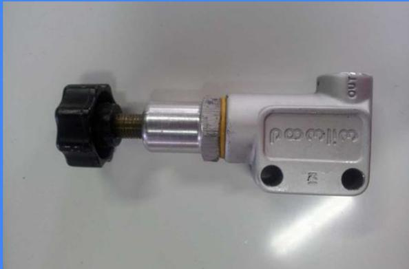
Algunos vehículos de competición usan un repartidor de frenada manual. Este repartidor de frenada hace que se pueda modificar manualmente la potencia de frenado que ejercemos sobre las ruedas delanteras o traseras, que puede interesarnos modificar según las condiciones de la carretera.
