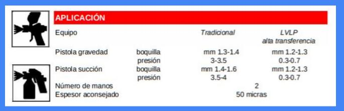
Este apartado especifica las pistolas que podemos utilizar y las boquillas y la presión que deben tener cada una de ellas para que la aplicación sea buena y tengamos un buen acabado.
